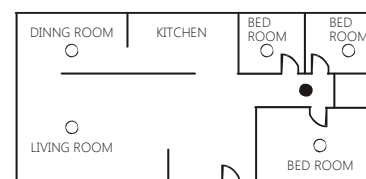
Фиг. 1: Места за поставяне на детектор за дим за единично жилище с една зона за спане
