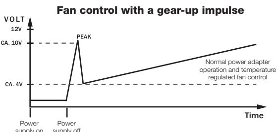
Система управления вентиляторами генерирует сигнал запуска. Этот короткий высоковольтный импульс гарантирует запуск всех подключенных корпусных вентиляторов.
