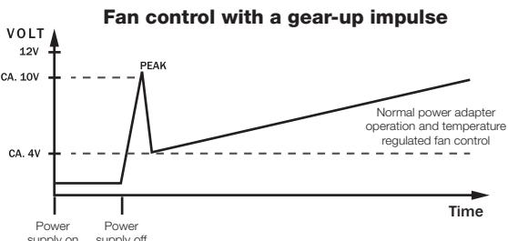
Si la temperatura aumenta, los ventiladores comienzan automáticamente a girar más rápido para garantizar una refrigeración de la caja rápida y eficaz. De este modo, la refrigeración rápida obtenida favorece la prolongación de la vida de sus componentes y bloque de alimentación.
