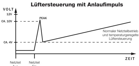
Die Lüftersteuerung verfügt über einen Anlaufimpuls. Damit wird sichergestellt, dass alle angeschlossenen Gehäuselüfter in jedem Fall anlaufen, da ein kurzer Impuls mit höherer Spannung die Lüfter startet.
