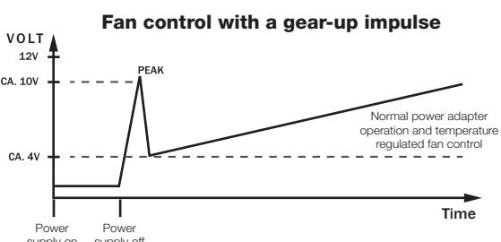
W razie podłączenia wentylatorów zewnętrznych do zasilacza należy upewnić się, czy nie są one sterowane technologią termosensoryczną lub potencjometrem. Regulacja wentylacji opiera się na impulsie rozruchowym. Krótki impuls o wyższym napięciu uruchamia wentylatory, dzięki czemu zapewniona jest praca wszystkich wentylatorów obudowy.
