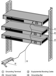
Figure 3-3 Equipotential Bonding
