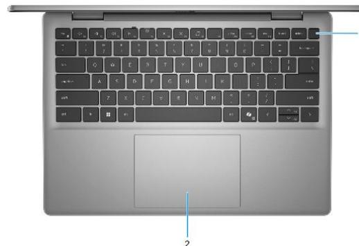
**Бележка:** Светлинният индикатор за състоянието на захранването на бутона за захранване е наличен само при компютри без четец за пръстови отпечатъци. Компютрите, които се доставят с вградения в бутона за захранване четец за пръстови отпечатъци, няма да имат лампичка за състояние на захранването върху бутона за захранване.
