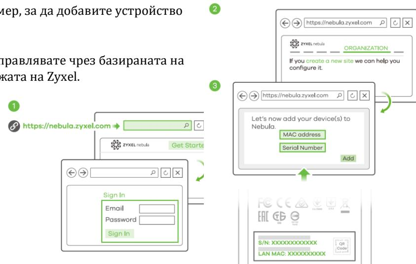
**3.** Въведете LAN MAC адреса и серийния номер (S/N) на NWA50AXPRO (вижте етикета на устройството) в екрана за конфигурация на NCC.
